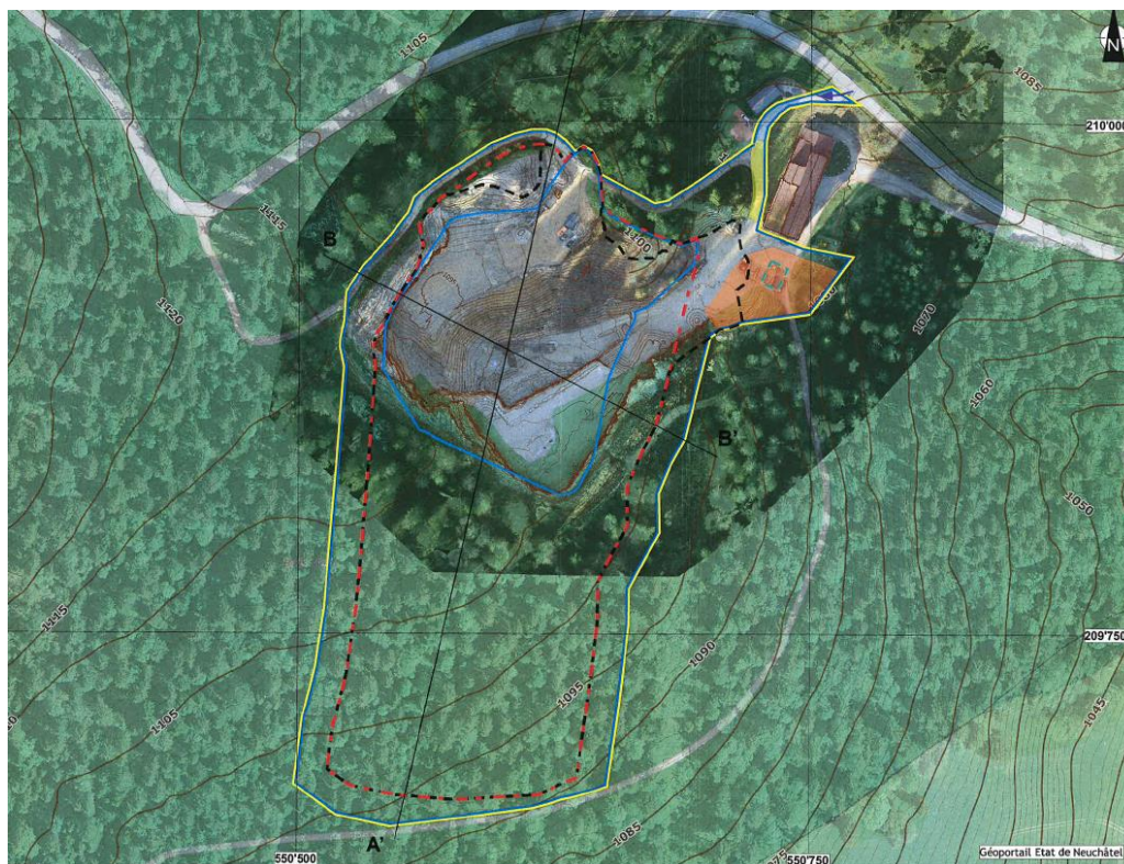
Traitillé rouge-noir : nouvelle zone d'extraction et de remblayage
